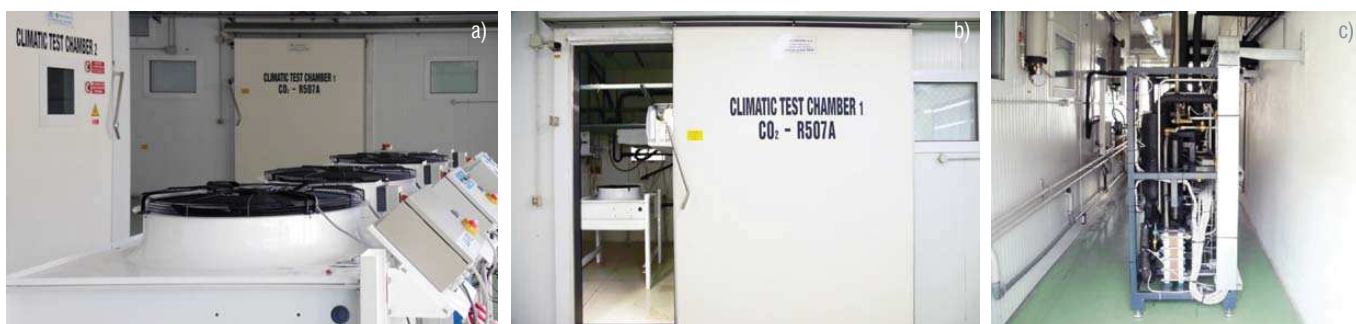
Rys. 2 – a) Laboratorium testowe; b) Klimatyczna komora testowa CO 2 ; c) Układy chłodnicze laboratorium testowego
